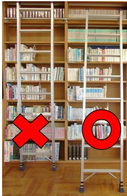
壁面の高い段にある本をとりたい場合は、はしごかステップを使います。はしごは、普段は棚に沿うように収納しています。使うときは、一番上のフックをポールに掛け、はしごの脚が床にしっかり固定されるように設置します。横から見ると、棚とはしごと床で直角三角形ができます。はしごを正しく設置しないまま使用すると危険ですので、十分に注意してください。
